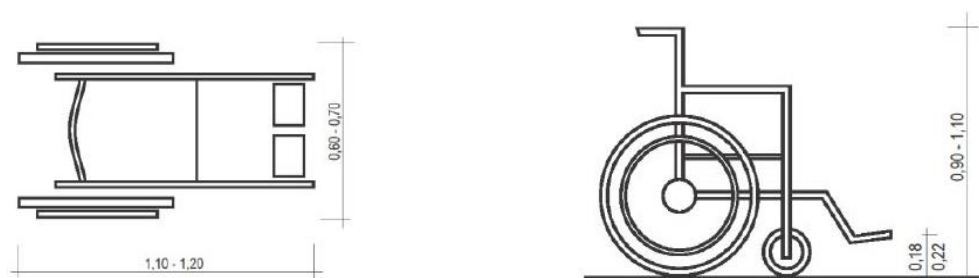
Σχήμα 5: Βασικές διαστάσεις χειροκίνητου αναπηρικού τροχοκαθίσματος.
