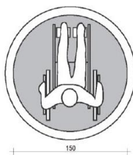
Σχήμα 6: Το αναπηρικό τροχοκάθισμα ή καρέκλα έχει βασικές διαστάσεις και ο τρόπος κίνησής του επιτρέπει την πλήρη επιτόπια στροφή που περικλείεται σε κύκλο διαμέτρου 1,50. μ.
