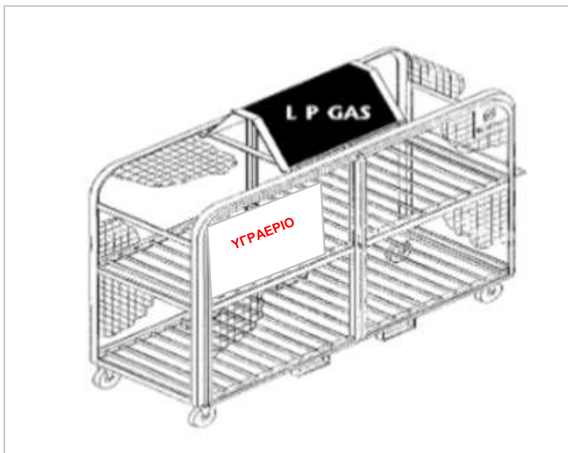
Εικόνα 11: Τυπικό κουβούκλιο για την αποθήκευση μέχρι 20 κυλίνδρων υγραερίου
