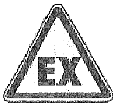
Εικ. 4.3: Προειδοποιητικά σήματα για τη σήμανση χώρων στους οποίους είναι δυνατό να δημιουργηθεί εκρήξιμη ατμόσφαιρα.
